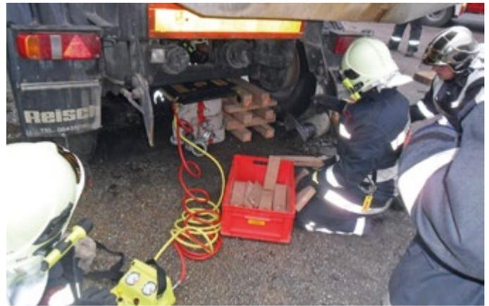
Technische Übung mit Hebekissen zur Befreiung einer eingeklemmten Person
